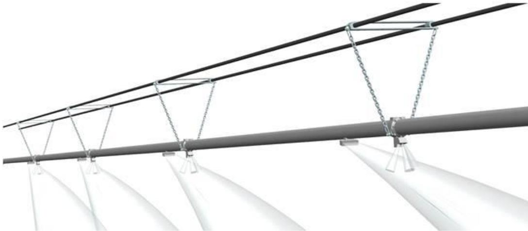
*Abbildung 6: Die Wasser- und Druckluftleitung werden an den Tragseilen aufgehängt.*
