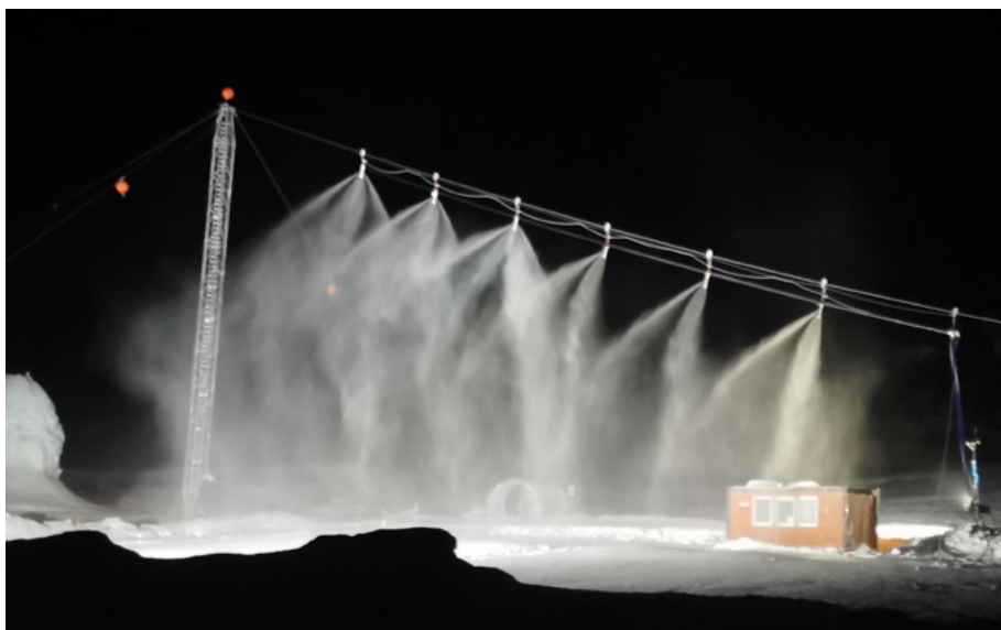
Bild 1: Testinstallation der Beschneigung ab Seil (bodenunabhängiges Beschneigungssystem) während der Versuche im Winter 2020/21 und 2022/23 (Bild: A. Bachmann).
