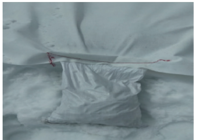
An den PLA Vlies angenähte Sand-Felsmaterialsäcke.
